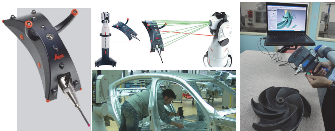
Рис. 1.8. Контроль с использованием координатных измерений
