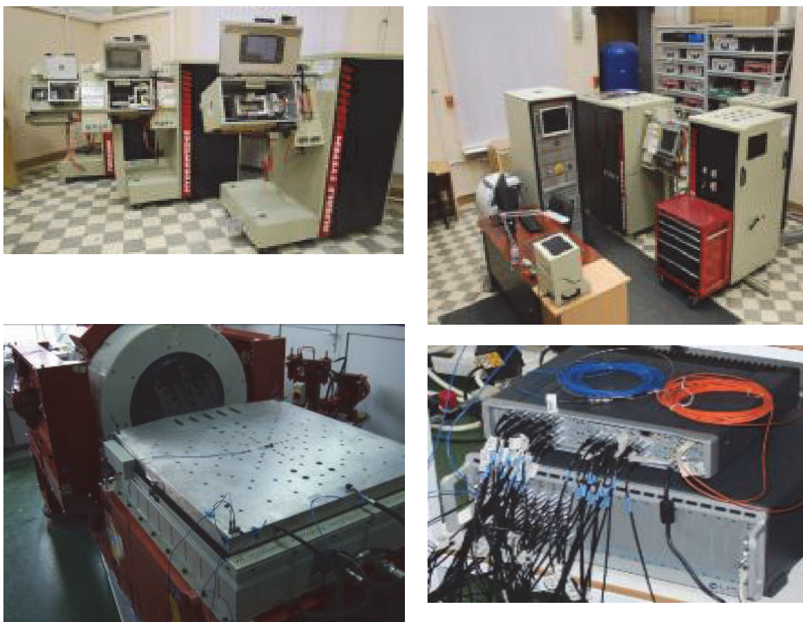
Рис. 1.26. Испытательный комплекс GLEEBLE 3800 и вибростенды в лабораториях ЮУрГУ
