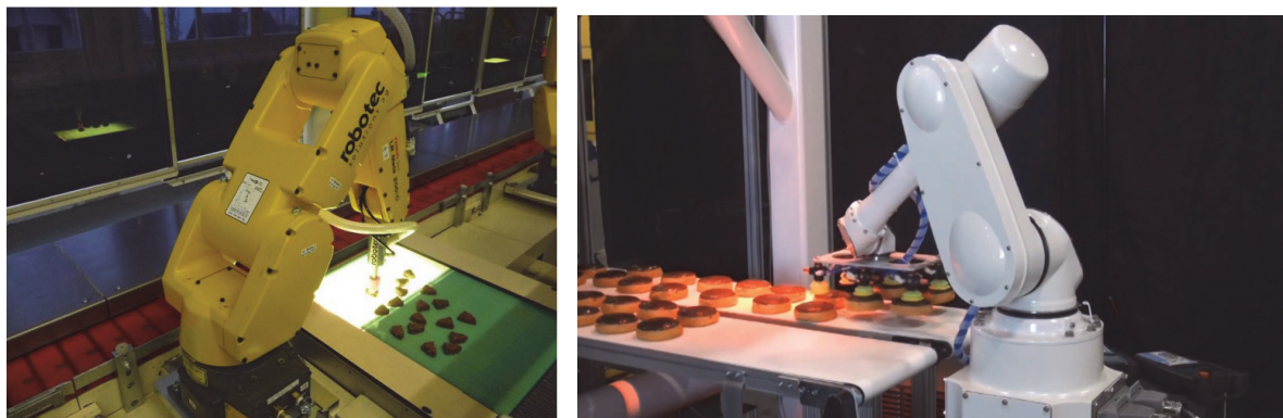
Рис. 1.23. Роботы в пищевом производстве: сортировка шоколадных конфет и оформление кексов
