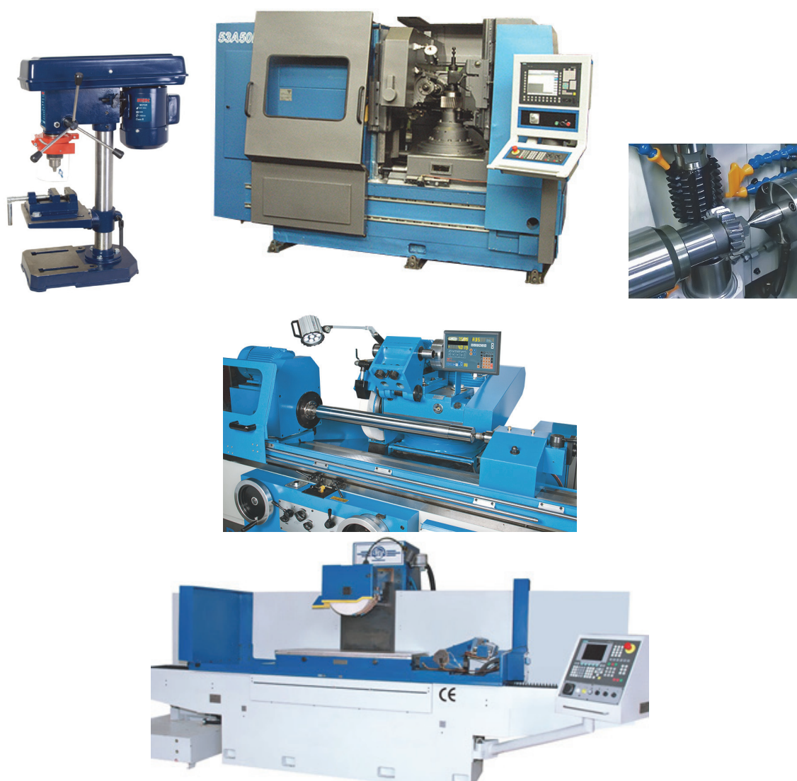
Рис. 1.11. Станки: сверлильный, зубофрезерный (справа фреза и заготовка в виде зубчатого колеса), круглошлифовальный и плоскошлифовальный
