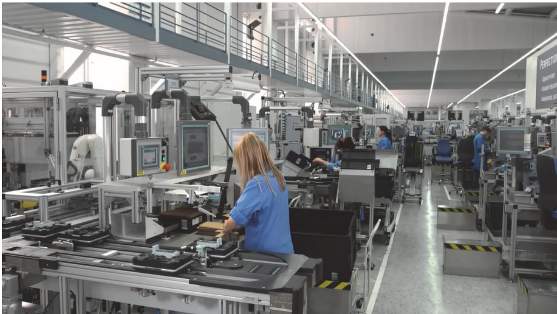
Рис. 1.34. Участки производства Siemens, соединенные беспроводными компьютерными сетями и перемещающиеся с операции на операцию заготовки с аналогичными системами
