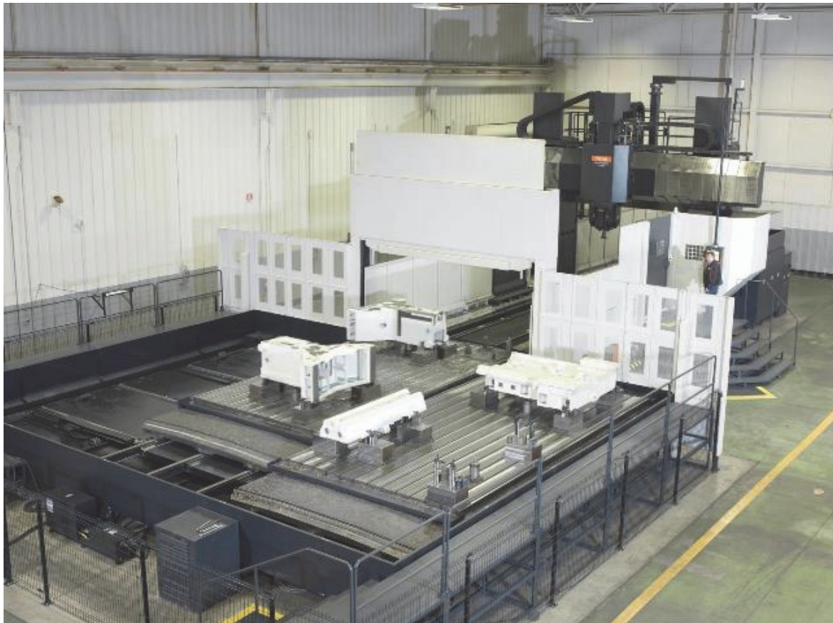
Рис. 2.4. Обрабатывающий центр, установка заготовок (оператор станка стоит справа)
