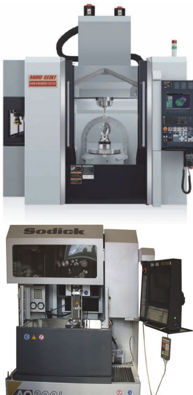
Рис. 1.5. Японский пятикоординатный фрезерный центр и четырехкоординатный проволочно-вырезной станок в научно-образовательном центре «Машиностроение» ЮУрГУ
