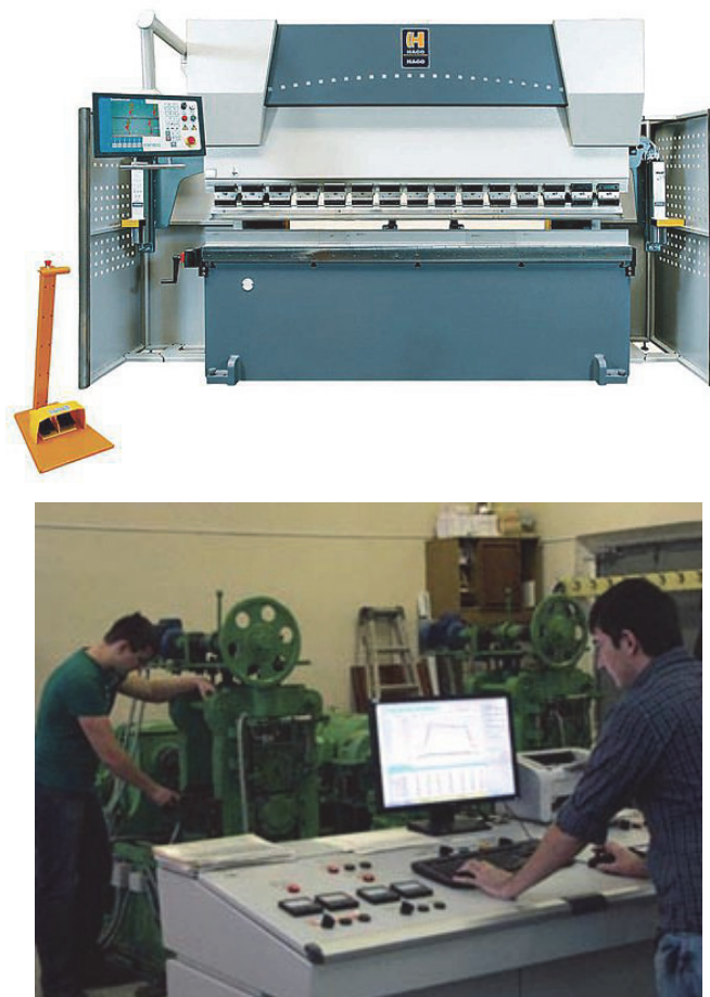
Рис. 1.14. Листогибочный пресс Насо и оборудование лаборатории ЮУрГУ
